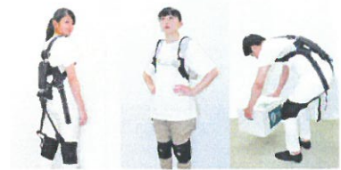
石井教授が開発した超軽量パワーアシストスーツ「エアロバック」。重量は 1.8kg以下、価格は130万円と、6人に1人の高齢者の約3分の1に抑えることに成功
